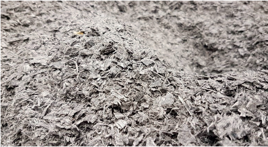
Bild 1. Gemahlene Tepex: Bei der Zerkleinerung kommt es auf die verwendeten Maschinen an. Insbesondere mit Einwellenzerkleinerern lässt sich ein homogenes Mahlglas erzeugen © Lanxess
